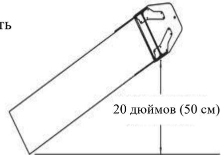
максимальное отклонение от продольной оси при повороте 20 дюймов (50 см) D2
